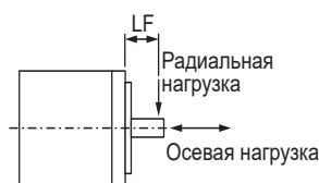
Рис. 4-2 Радиальные и осевые нагрузки двигателя
