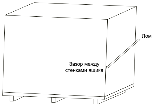
Рисунок 3.1 – Разборка упаковочного ящика
