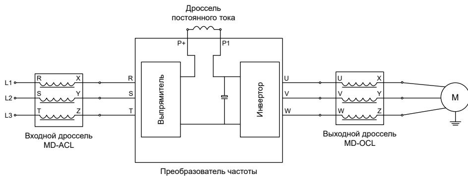
Рисунок 2.9 – Общая схема подключения MD-ACL и MD-OCL
