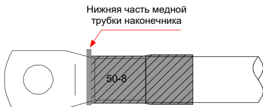
Рис. 3-36 Термоусадочная трубка, закрывающая жилу кабеля
