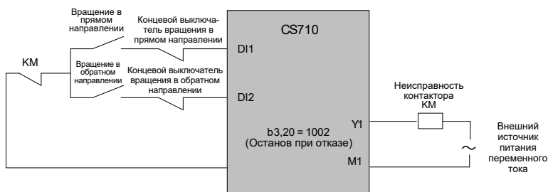
Рис. 5-10 Цепь предела безопасности и останова при отказе
