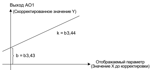
Рис. 5-8 Кривая корректировочной характеристики выхода АО1
