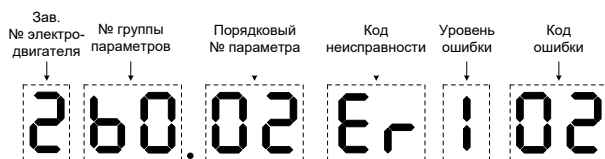
Рис. 4-2 Пример отображения данных на светодиодном дисплее
