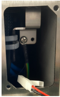
Рисунок 6.2 – Подключение новой батареи к свободному разъёму
