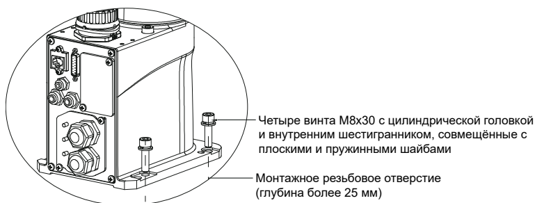
Рисунок 4.1 – Настольная установка основания робота
